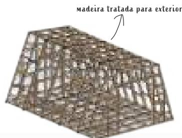
**Estrutura** base em vigas de madeira tratada para exterior, com reforços transversais feito através de um sistema de encaixe desenvolvido no Japão há milhares de anos e ainda hoje em utilização.
